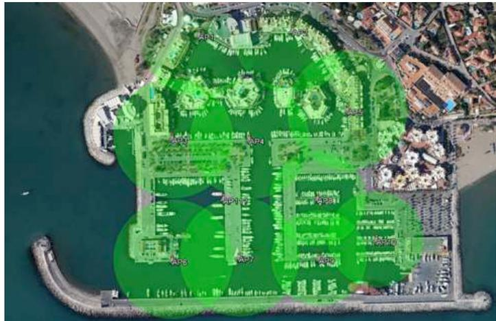
En la siguiente figura se muestra la cobertura prevista para cada punto de acceso, de forma que la maya de cada uno de ellos tanto en 2.4GHz y 5Ghz sea adaptable en función del radio de cobertura de los clientes, la potencia en dicha maya que se la asignará directamente el controlador Wireless, de tal forma nos aseguramos la máxima cobertura en cada momento para cualquier cliente de baja ganancia a nivel del suelo, como pueda ser un teléfono móvil o un ordenador portátil:
